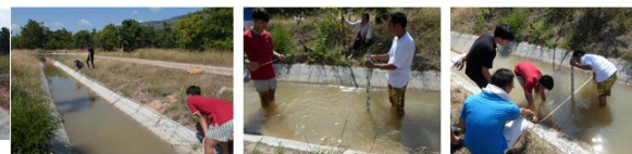
วัดขนาดหน้าตัดและความลึกของน้ำในคลองสำหรับการคำนวณหาการรั่วซึม
